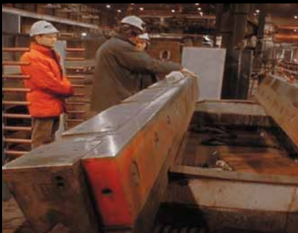
Toolox 44 Schermesser nitriert -8000 Schnitte bis 35 mm 960 MPa
